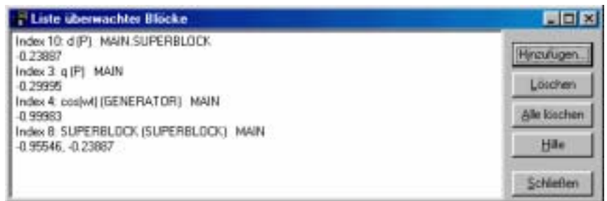
Das BORIS-Fenster zur Überwachung von Blöcken
